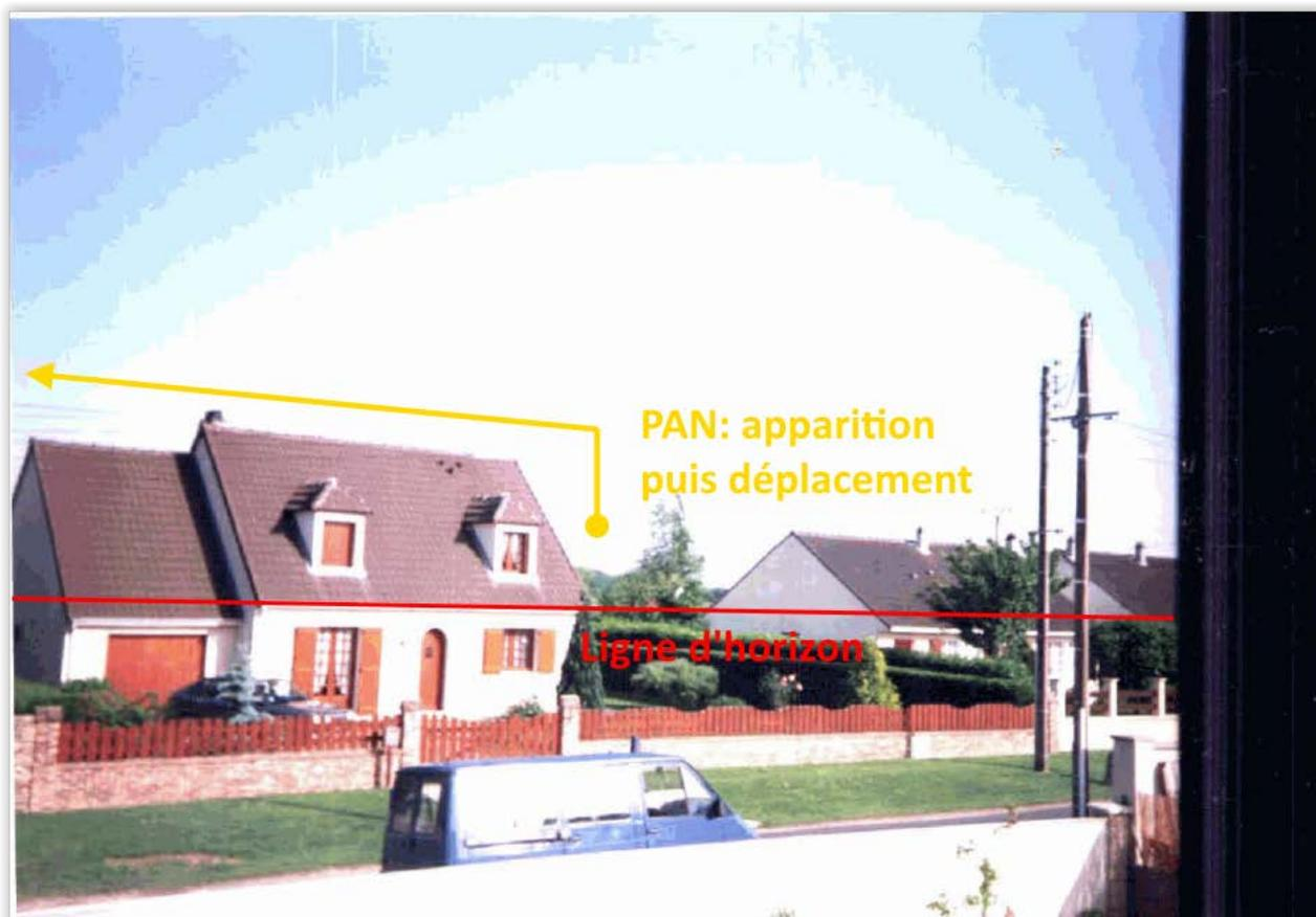
L'étape suivante consiste à effectuer les mesures angulaires séparant cette ligne d'horizon aux positions successives du PAN.
